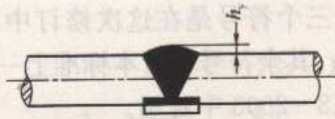
图2 焊缝余高 ( h_y )
