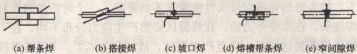
图 10 钢筋电弧焊接头拉伸试验断于焊缝示意
