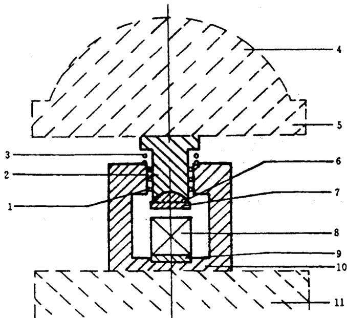
1—滚珠轴承；2—滑块；3—复位弹簧；4—压力机球座；5—压力机上压板；6—夹具球座；
