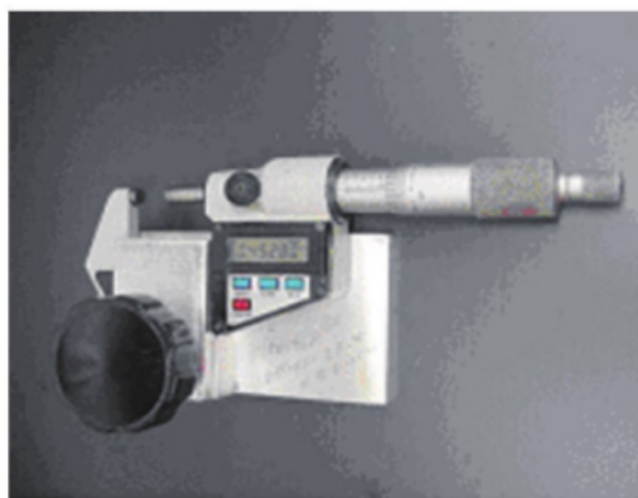
图 8 千分尺安装在高度调节板上
