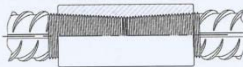
图 6 标准型锥螺纹连接件示意图
